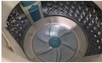
図② 洗濯槽(筆者宅の洗濯機) 側面 糸くずフィルター 底部 パルセーター(回転板)
