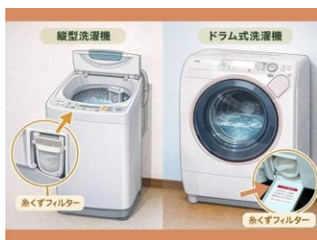
図④ フィルター位置(縦型・ドラム式) https://monosyuuri.com/home/washing-machine-lint-filter-cleaning
